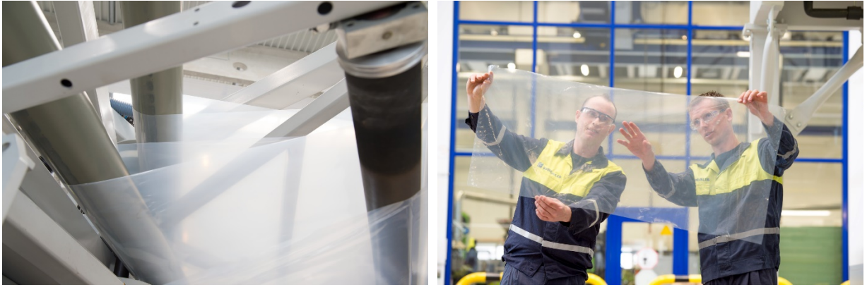
图片：在北欧化工创新总部的七层共挤设备上生产的 Anteo 薄膜产品
